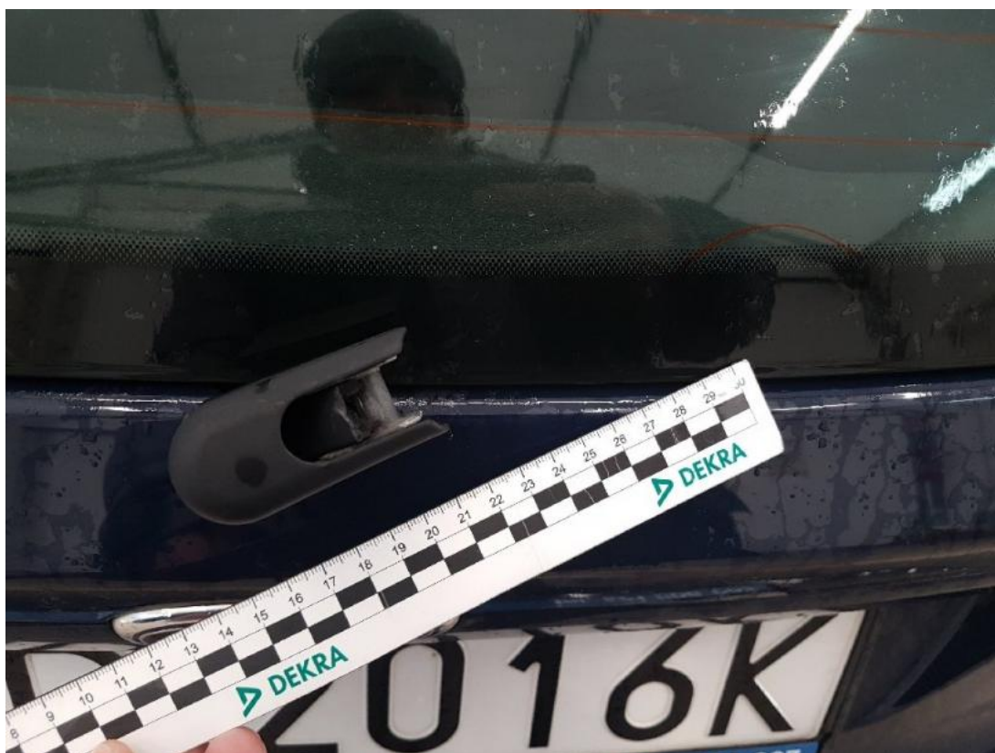
Fot. 40 Ramię wycieraczki tył (Pęknięcie/Rozerwanie)
