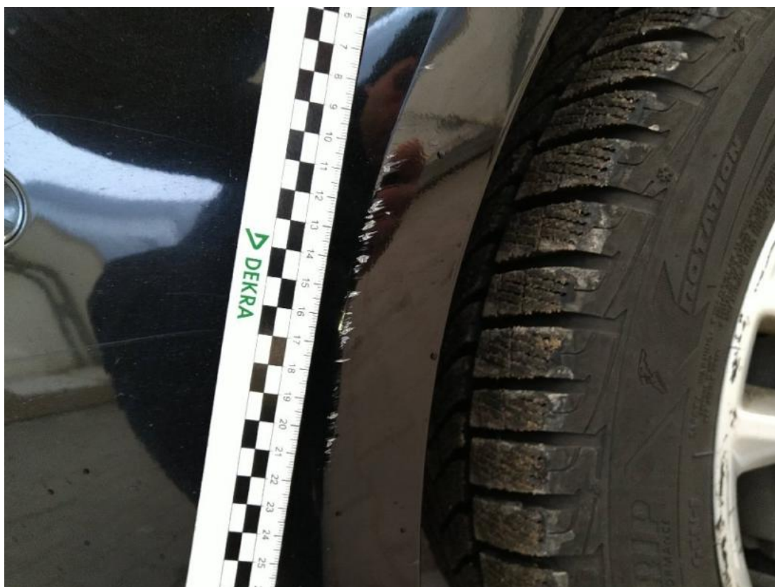
Fot. 26 Zderzak (Rysa/Odprysk)
