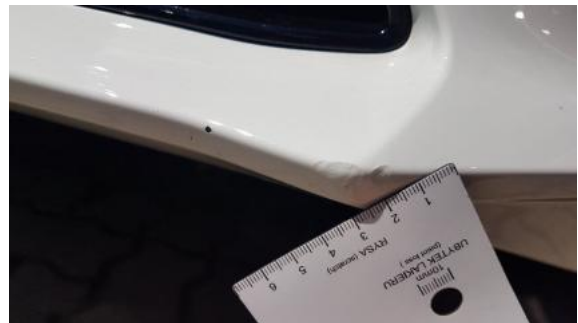
Fot. 26 Zderzak (Rysa/Odprysk)
