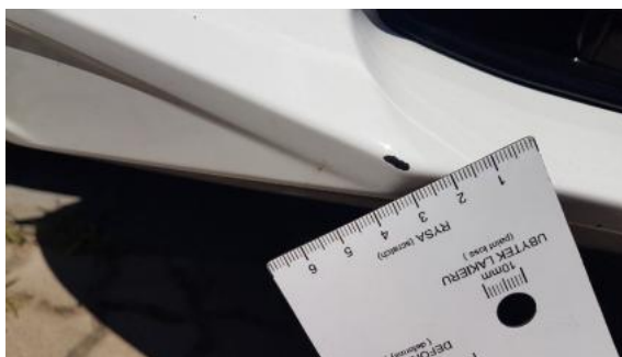
Fot. 27 Zderzak (Rysa/Odprysk 1)
