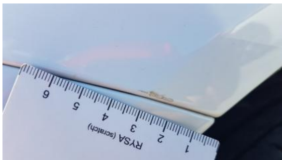
Fot. 29 Błotnik przedni lewy (Rysa/Odprysk)
