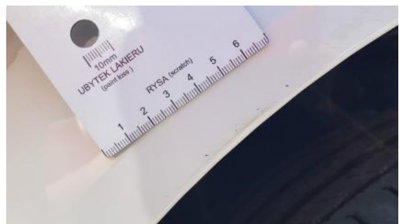
Fot. 28 Zderzak (Rysa/Odprysk 2)
