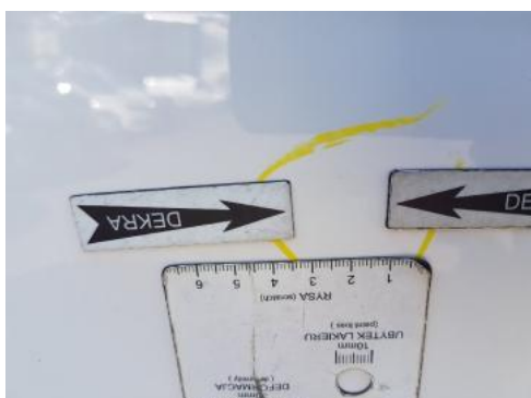
Fot. 29 Drzwi przednie prawe (Wgniecie./Odształ.)
