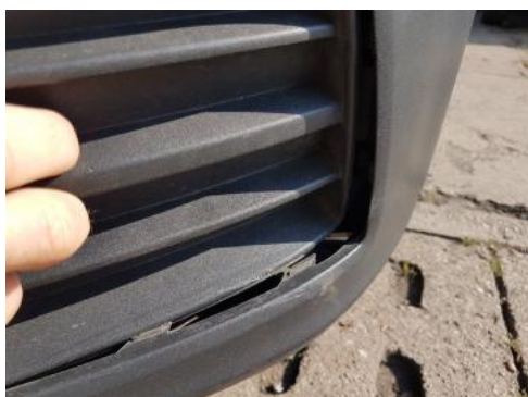
Fot. 27 Krata wlotu powietrza, zderzak przedni (nieprawidłowe zamocowanie)
