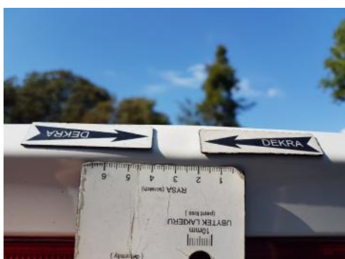
Fot. 31 Pokrywa bagażnika (Wgniecie./Odształ.)
