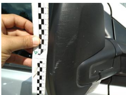
Fot. 23 Lusterko zewnętrzne prawe (Rysa/Odprysk)
