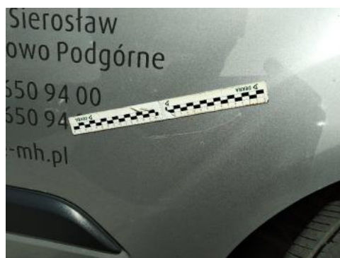
Fot. 24 Drzwi przednie prawe (Rysa/Odprysk)
