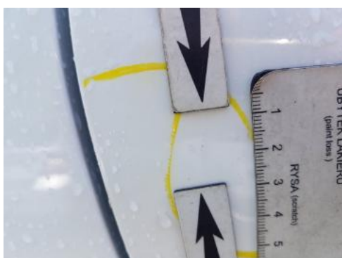
Fot. 27 Drzwi tylne prawe (Wgniecie./Odształ.)
