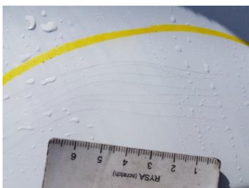
Fot. 35 Zderzak tylny (Pęknięcie/Rozerwanie)
