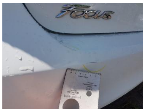
Fot. 32 Zderzak tylny (Rysa/Odprysk)
