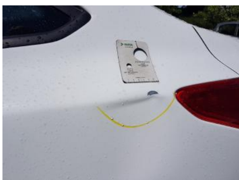
Fot. 39 Błotnik tylny lewy/ściana boczna lewa (Wgniecie./Odształ.)
