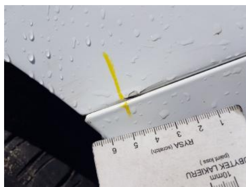
Fot. 38 Błotnik tylny lewy/ściana boczna lewa (Rysa/Odprysk)
