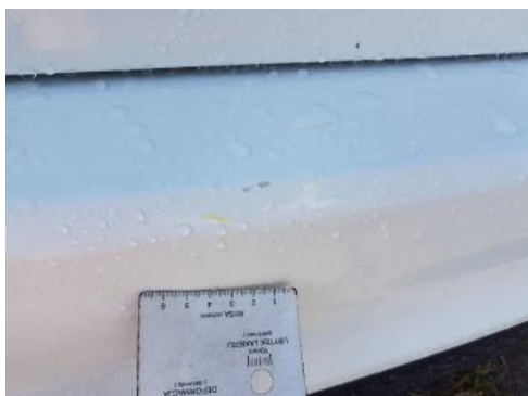
Fot. 33 Zderzak tylny (Rysa/Odprysk 1)
