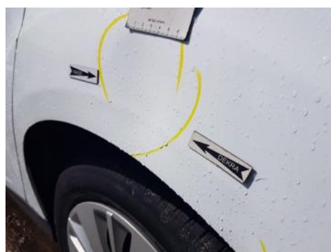
Fot. 40 Błotnik tylny lewy/ściana boczna lewa (Wgniecie./Odształ. 2)
