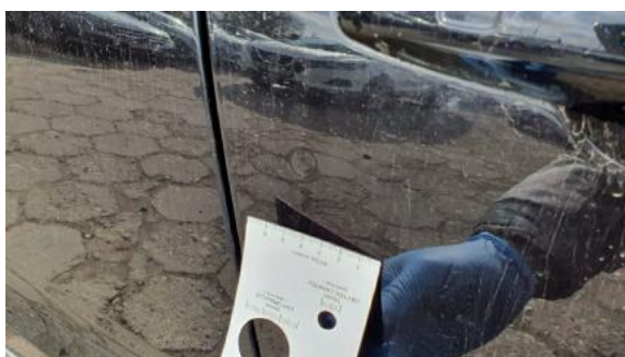
Fot. 31 Drzwi przednie prawe (Wgniecie./Odształ.)
