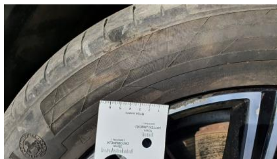
Fot. 30 Opona przednia prawa (Wgniecie./Odształ.)
