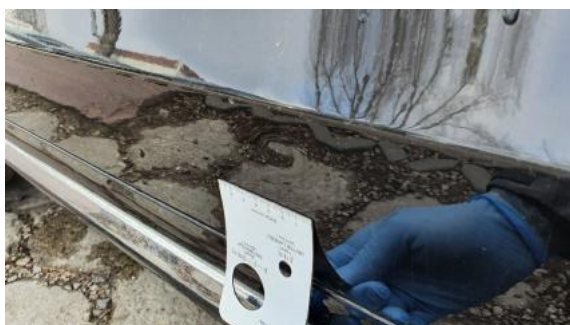
Fot. 45 Drzwi przednie lewe (Wgniec./Odształ. 1)
