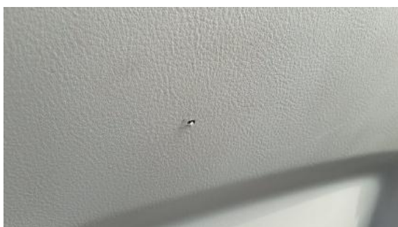
Fot. 55 Fotel prawy (Pęknięcie/Rozerwanie)
