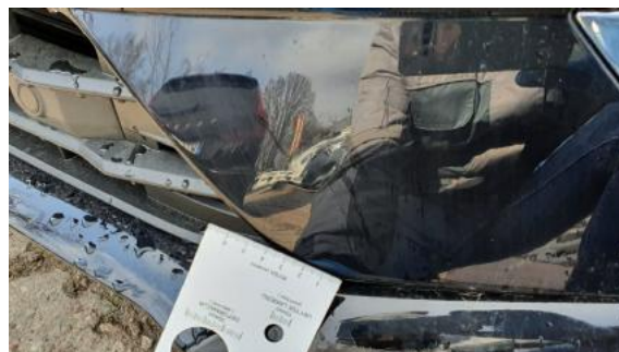
Fot. 26 Zderzak (Wgniecie./Odształ.)
