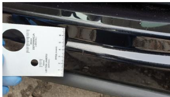
Fot. 42 Próg lewy (Rysa/Odprysk)
