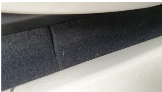
Fot. 49 Wykładzina podłogi (przepalenie)
