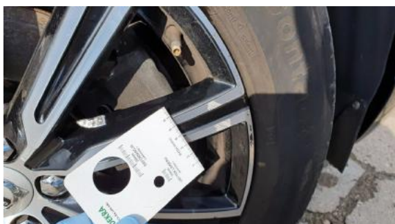
Fot. 29 Felga przednia prawa (Rysa/Odprysk 1)
