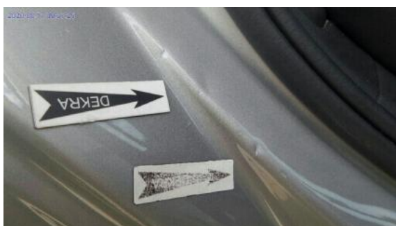
Fot. 39 Błotnik tylny prawy/ściana boczna prawa (Wgniecie./Odkształ.)
