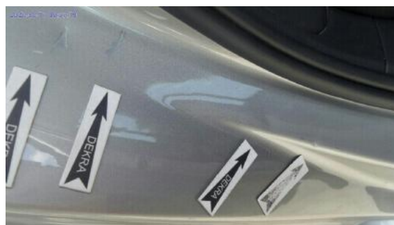
Fot. 38 Błotnik tylny prawy/ściana boczna prawa (Rysa/Odprysk)
