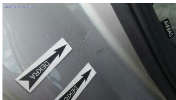
Fot. 40 Błotnik tylny prawy/ściana boczna prawa (Wgniecie./Odkształ. 2)
