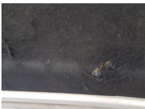
Fot. 27 Wykładzina pokrywy komory silnika (Pęknięcie/Rozzerwanie)
