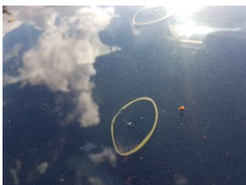
Fot. 31 Szyba czołowa (Pęknięcie/Rozzerwanie 2)
