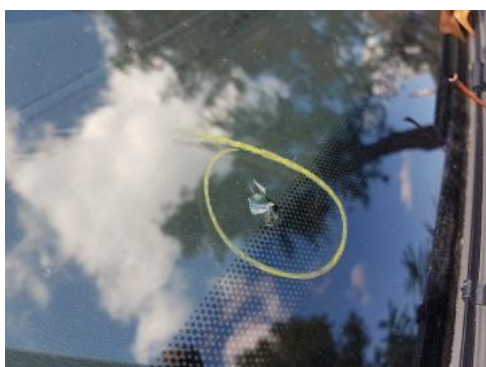
Fot. 29 Szyba czołowa (Pęknięcie/Rozzerwanie)
