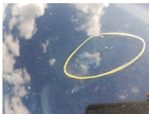
Fot. 30 Szyba czołowa (Pęknięcie/Rozzerwanie 1)
