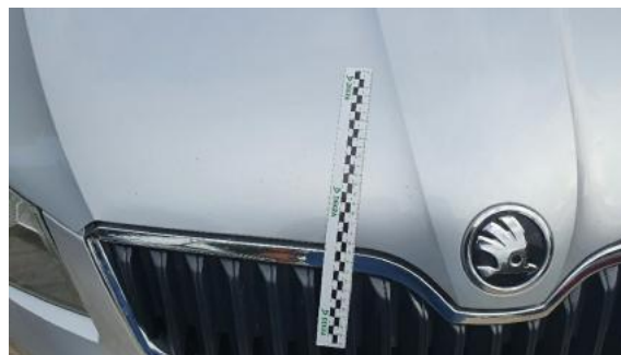
Fot. 26 Pokrywa komory silnika (Rysa/Odprysk)
