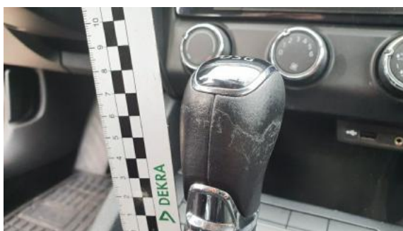
Fot. 59 pp_galka_dzwigni_zmiany_biegow (Rysa/Odprysk)
