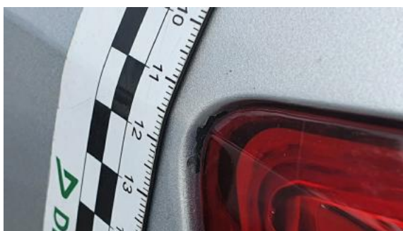
Fot. 43 Błotnik tylny lewy/ściana boczna lewa (Rysa/Odprysk)
