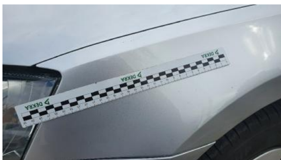
Fot. 53 Błotnik przedni lewy (Rysa/Odprysk)
