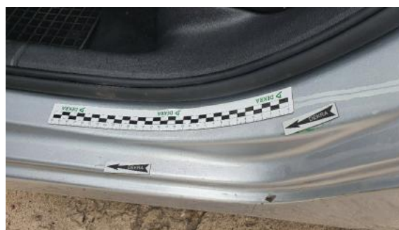
Fot. 48 Próg lewy (Wgniecie./Odkształ.)
