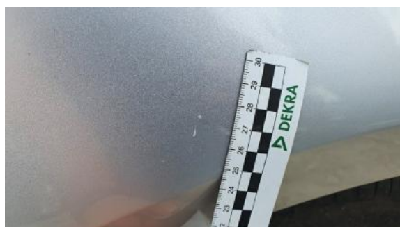
Fot. 31 Błotnik przedni prawy (Rysa/Odprysk)
