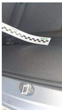
Fot. 61 Wykładzina słupka tylnego lewego (Rysa/Odprysk)
