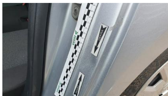
Fot. 44 Błotnik tylny lewy/ściana boczna lewa (Wgniecie./Odkształ.)
