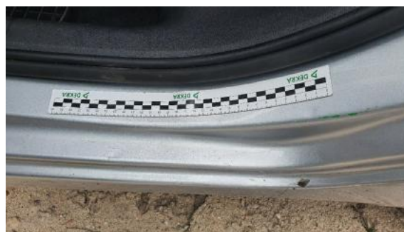
Fot. 46 Próg lewy (Rysa/Odprysk)
