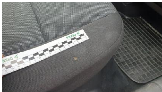
Fot. 62 Kanapa tylna (Pęknięcie/Rozerwanie)
