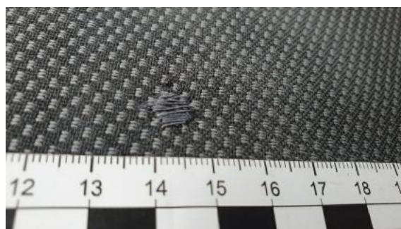
Fot. 56 Fotel lewy (Pęknięcie/Rozerwanie 1)
