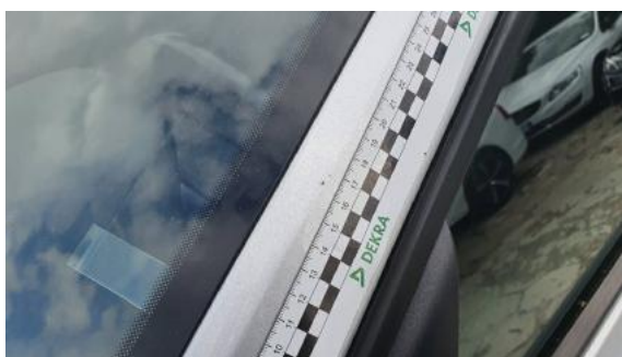
Fot. 51 Słupek przedni lewy (Rysa/Odprysk)
