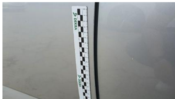
Fot. 50 Drzwi przednie lewe (Rysa/Odprysk 1)
