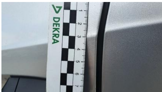
Fot. 49 Drzwi przednie lewe (Rysa/Odprysk)
