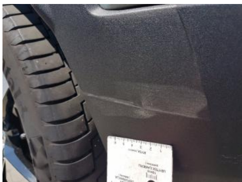
Fot. 33 Zderzak tylny (Rysa/Odprysk 1)
