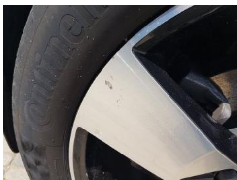
Fot. 38 Felga przednia lewa (Rysa/Odprysk)
