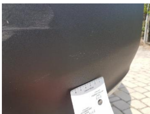
Fot. 36 Zderzak tylny (zarysowanie)
