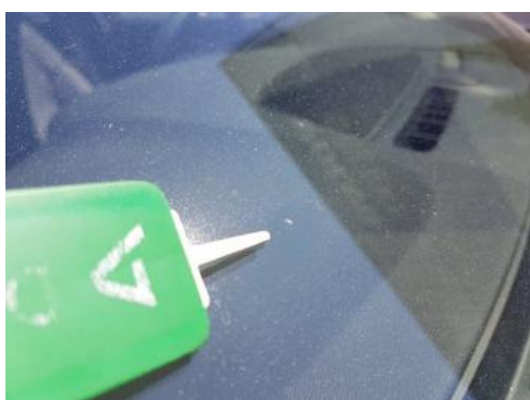
Fot. 27 Szyba czołowa (Rysa/Odprysk)
