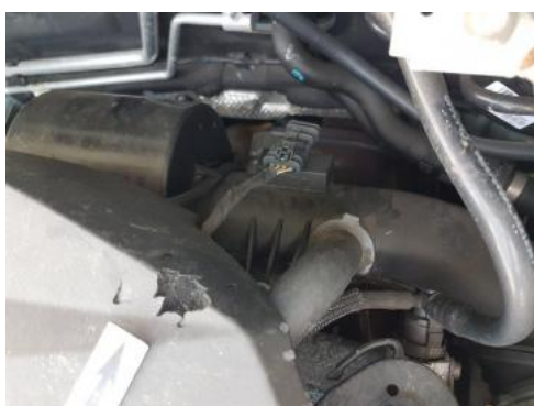
Fot. 39 Osłona silnika (ubytki materiału)
