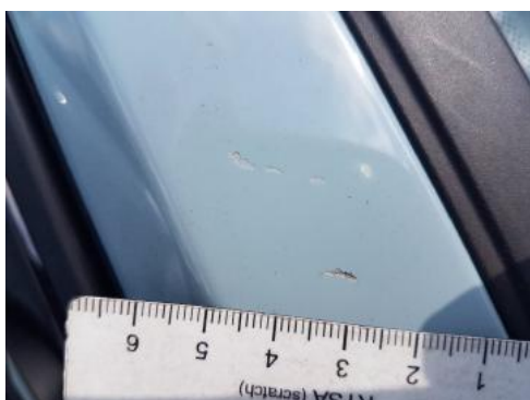
Fot. 29 Słupek przedni prawy (Rysa/Odprysk)
