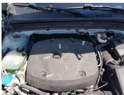
Fot. 40 Osłona silnika (ubytki materiału)
