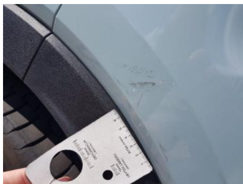
Fot. 34 Zderzak tylny (Rysa/Odprysk 2)
