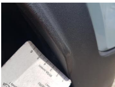
Fot. 35 Zderzak tylny (zarysowanie)
