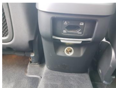
Fot. 56 Zaślepka gniazda 12V (brak)
