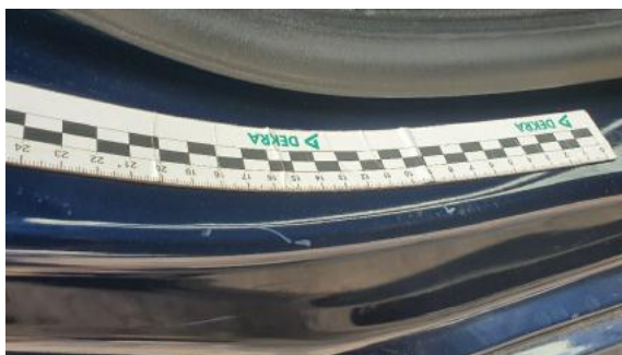
Fot. 27 Próg prawy (Rysa/Odprysk)
