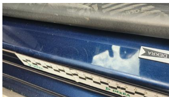
Fot. 36 Próg lewy (Rysa/Odprysk)
