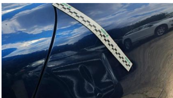
Fot. 31 Błotnik tylny lewy/ściana boczna lewa (Rysa/Odprysk)
