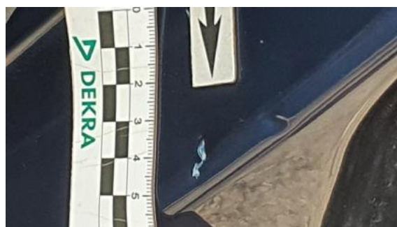
Fot. 40 Słupek środkowy lewy (Wgniecie./Odkształ.)
