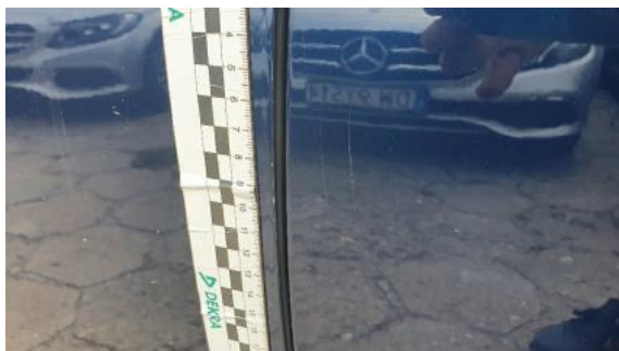
Fot. 33 Drzwi tylne lewe (Rysa/Odprysk 1)
