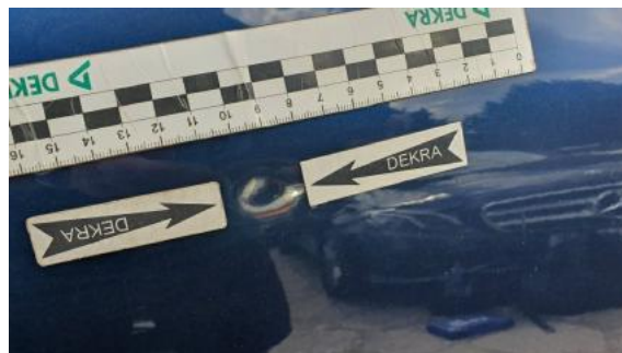
Fot. 34 Drzwi tylne lewe (Wgniecie./Odkształ.)
