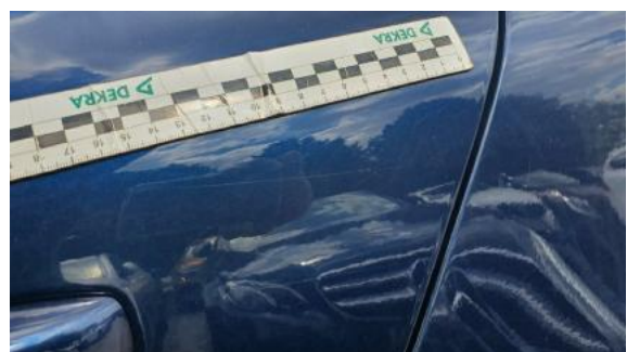
Fot. 32 Drzwi tylne lewe (Rysa/Odprysk)
