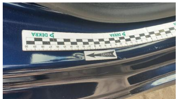
Fot. 28 Próg prawy (Wgniecie./Odształ.)
