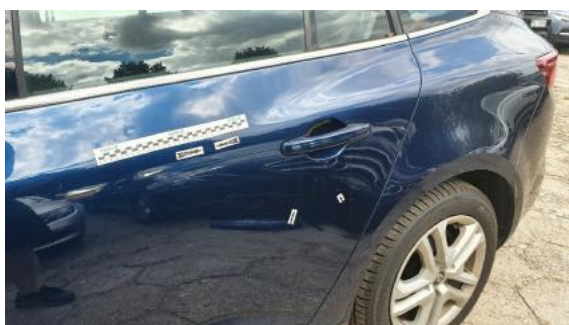
Fot. 35 Drzwi tylne lewe (Wgniecie./Odkształ. 1)
