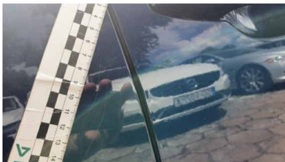
Fot. 29 Drzwi tylne prawe (Rysa/Odprysk)
