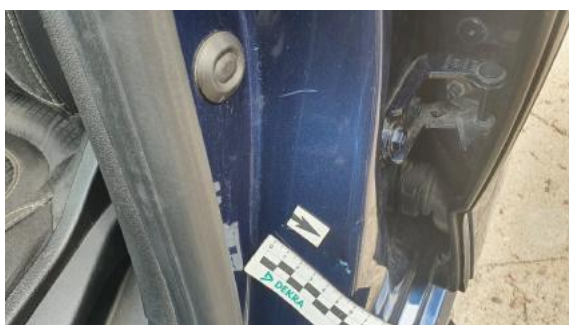
Fot. 39 Słupek środkowy lewy (Rysa/Odprysk)
