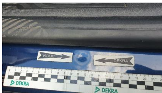
Fot. 38 Próg lewy (Wgniecie./Odkształ.)
