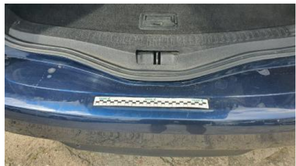
Fot. 30 Zderzak tylny (Rysa/Odprysk)
