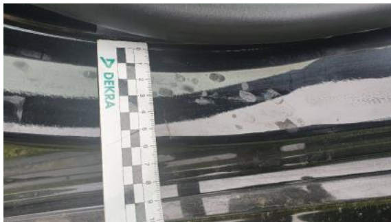
Fot. 25 Próg prawy (Rysa/Odprysk)
