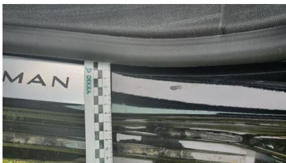
Fot. 27 Próg lewy (Rysa/Odprysk)
