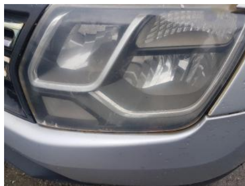
Fot. 42 Reflektor lewy (zabrudzenia wewnętrzne)
