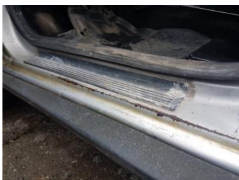
Fot. 29 Próg lewy (korozja)
