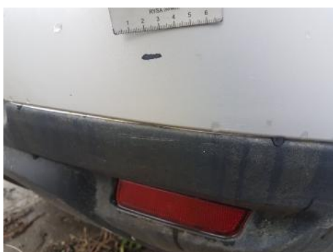
Fot. 27 Zderzak tylny (Rysa/Odprysk)
